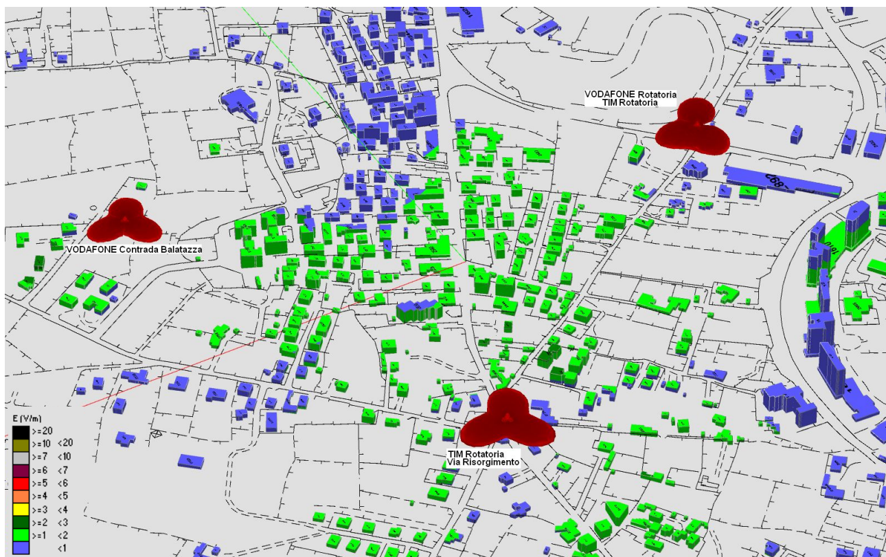
Fig. 2 Impatto Elettromagnetico – Zona Via del Risorgimento -Ipotesi 2 – 120°Nord
