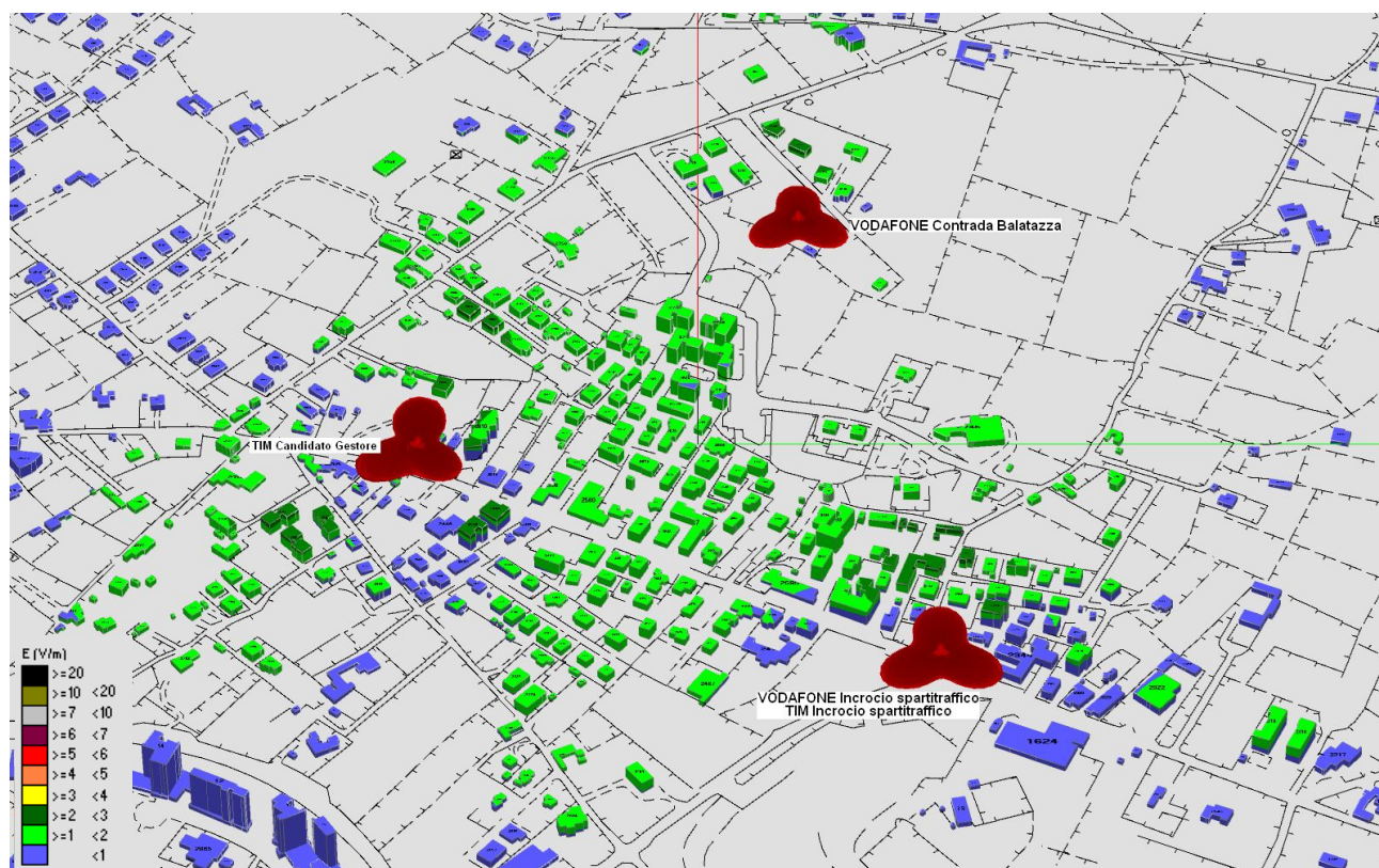
Fig. 6 Impatto Elettromagnetico – Zona Via del Risorgimento -Ipotesi 3 – 0°/Nord
